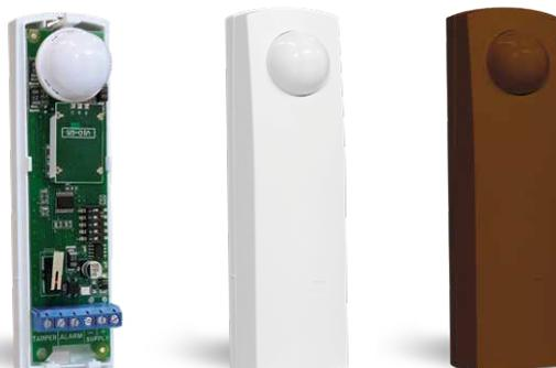
Détecteur à double technologie, infrarouge et hyperfréquences à 10 GHz pouvant créer une protection de type "rideau" pour les portes et les fenêtres. Il a une portée réglable de 2 à 3,5 m. Équipé d'une autoprotection à l'arrachement et à l'ouverture, d'un LED de signalisation avec son dip-switch de désactivation. Il dispose d'un système de reconnaissance de la direction de l'alarme.
